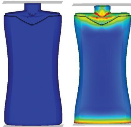
Instron 頂部載荷作用測試顯示 22g 瓶子的實際變形 頂部載荷作用模擬顯示 22g 瓶子的變形和壁厚 實際測試和模擬分析的應力和變形曲線比較
