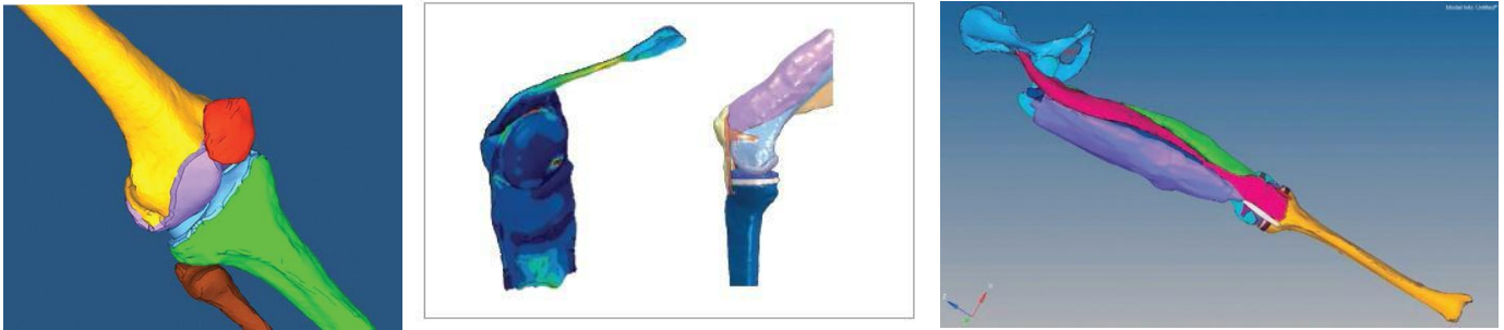
HyperMesh 構建的自然膝關節模型 股骨屈曲角度為 60° 時的股四頭肌變形情況 用於進行有限元模擬的整體幾何模型
