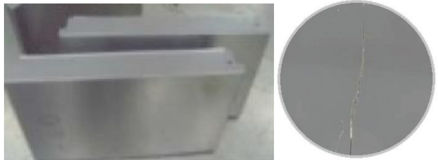
溫度迴圈後冰箱門蓋開裂
